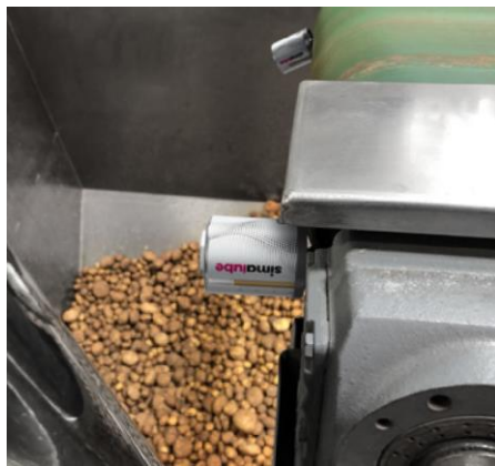
두 개의 simalube 자동 주입기가 감자가공에서 컨베이어 벨트의 디플렉터 롤러의 베어링을 윤활합니다.
