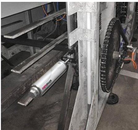
simalube 250ml 자동주입기와 플랫폼 브러시를 이용한 체인 윤활
