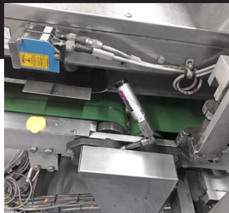
칩(크립스)의 생산에 있어서 컨베이어 벨트의 구동 롤러의 베어링 윤활
