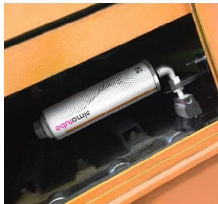
재활용 공장의 컨베이어 벨트 체인은 자동으로 윤활되고 브러쉬로 세척됩니다.
