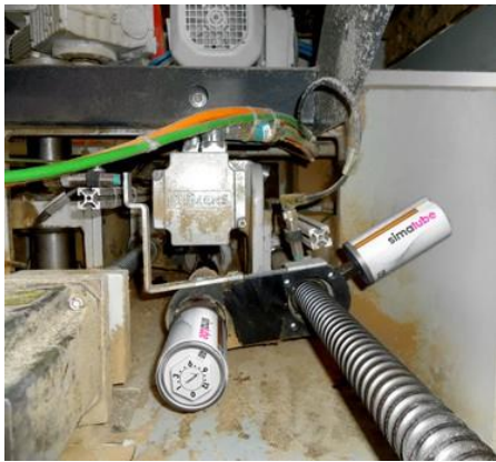
등근 톱의 스피들은 2개의 simalube 125ml 자동주입기로 윤활됩니다.
